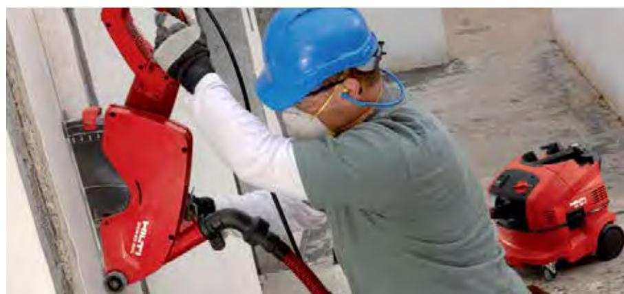
Yeni Hilti elektrikli kesme makinesi DCH 300 elmaslı kesme bıçakları donatılı beton, doğal taş ve tuğla gibi birçok mineral malzemede 120 mm derinliğe kadar kesim imkanı sağlar.
