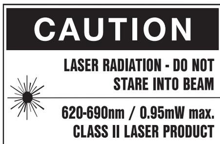
Comprimento de onda do laser 620-690 nm. Nas condições atrás mencionadas, a potência de saída média é de 0,95 mW.
