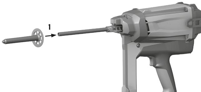
La guida chiodi trattiene il tassello per materiale isolante ed inserisce l'elemento di fissaggio durante il processo di applicazione nel punto desiderato nel materiale di base.
